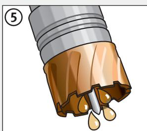
Grazie al dispositivo di lubrificazione automatica, l'olio da taglio viene rilasciato dove serve. Una quantità costante ed uniforme di lubrificante viene distribuita su tutta l'area di taglio. La fresa è costantemente lubrificata, pertanto non si surriscalda e non c'è specco di lubrificante. Questo aumento la durata delle frese e le prestazioni di foratura.
