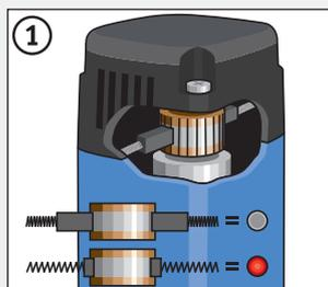
I perforatori della serie Profi-PLUS sono dotati di indicatore dell'usura dei carboncini. Sostituendo per tempo le spazzole si salvaguarda il motore del vostro perforatore da danni.
