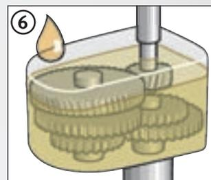
La scatola ingranaggi è una delle caratteristiche più importanti e distintive dei perforatori BDS. Queste macchine hanno una scatola ingranaggi multi-stadio a bagno d'olio. Questo sistema consente la lubrificazione costante e uniforme di tutti gli ingranaggi garantendo ai perforatori BDS una lunga vita operativa.
