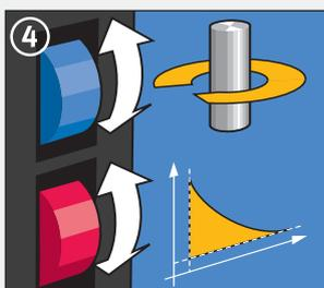
L'elettronica „full wave“ permette al motore di adattarsi costantemente al carico di lavoro. Il motore, in questo modo, eroga la massima potenza anche con velocità di rotazione molto basse, garantendo una resa operativa costante. Se la coppia richiesta è eccessiva, il limitatore elettronico si attiva spegnendo la macchina ed evitando la rottura dell'utensile. BDS Maschinen ricerca la massima sicurezza operativa.
