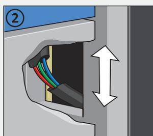
I perforatori elettromagnetici BDS sono più sicuri da maneggiare grazie al cablaggio elettrico interno che evita il danneggiamento dei cavi.
